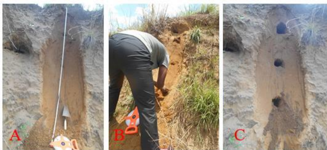
Photo A : préparation du site de prélèvement ; Photo B : délimitation des profondeurs à l'aide du double décimètre et échantillonnage à l'aide de la truelle ; Photo C : disposition des trous de prélèvements sur la paroi du ravin des sols (cliché Dorvelon NGAMBAON, 2021)
